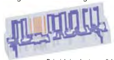
Beispiel einer konturparallelen, segmentierten Temperierung
